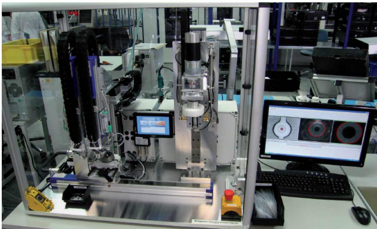
Neue Anlage: Das Aufzeigersystem mit Kameravermessung und Kraftweg-Messung.
