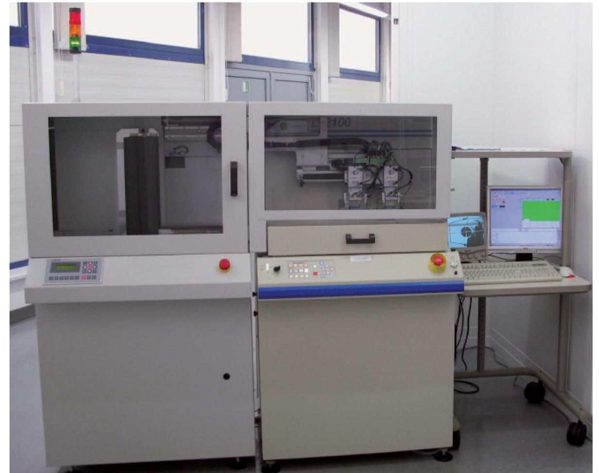
Höchste Qualität: Der Strukturierungslaser in der Fertigung von Klimasensoren.
